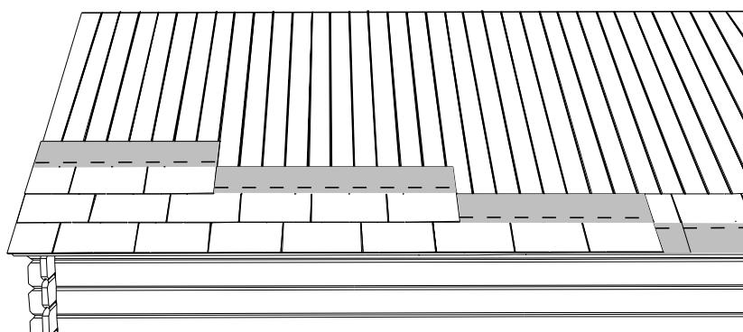
**NL:** Voor het afdekken van de nok dient U de shingles schuin in stukken te snijden zoals op de tekening op de pakken. Vervolgens legt U deze stukken overlappend op elkaar. Hou rekening met de richting van de stormwind bij de bepaling in welke richting U zal overlappen. Vernagel met 2 nagels op de plaats die door het volgende stuk wordt overlaapt.
